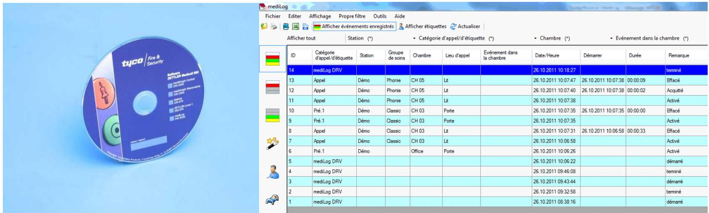
Le logiciel Medilog permet l'enregistrement et l'archivage des données transmises sur le bus de donnée. Toutes les actions de présences, d'appels, de concentration, de réponse à partir de l'interface LVTI ou de défauts sont enregistrées en fonction de la date et de l'heure.
